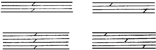
图 7 接缝在三合板与五合板中的布置方式
